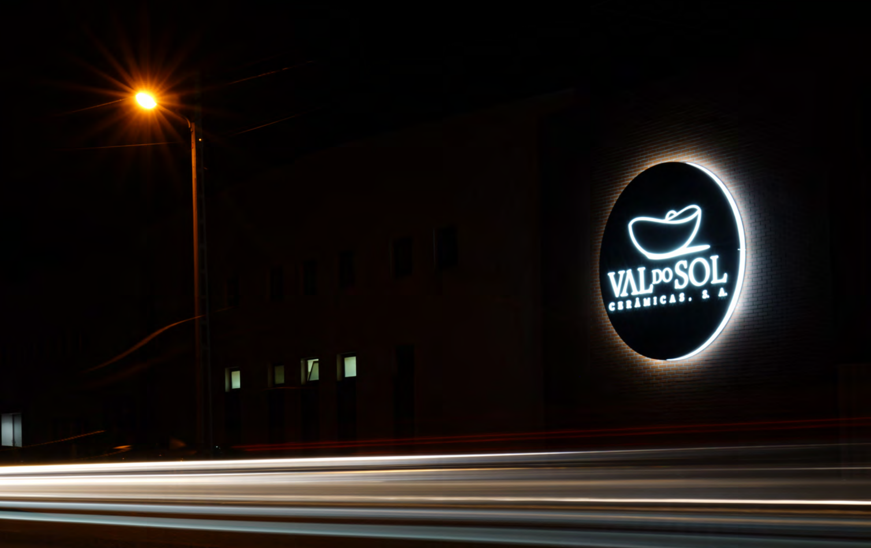
RECLAMO LUMINOSO CIRCULAR 4000X4000MM ALUMÍNIO CORTADO A CNC E LACADO À COR COM FRENTE MAQUINADA A NEGATIVO NAS LETRAS, ACRÍLICO OPALINO APLICADO NA PARTE DE TRÁS, FUNDO EM ALUMÍNIO E ACRÍLICO OPALINO EM TODA A VOLTA, DE FORMA A SAIR LUZ LED NAS LETRAS E LATERAIS
