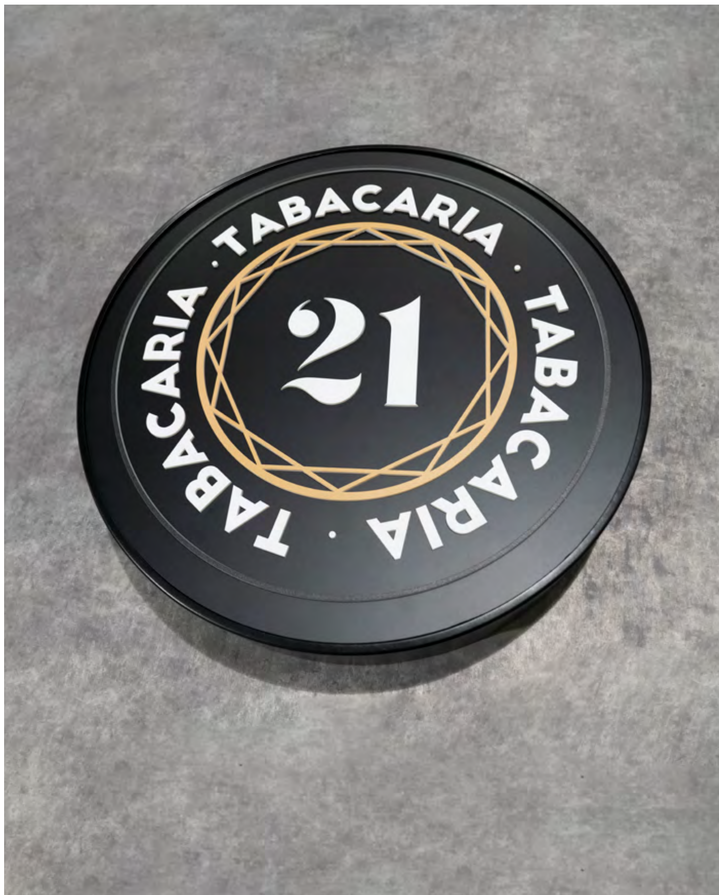
RECLAMO LUMINOSO EM MONOFACE 800X800MM ESTRUTURA EM ALUMÍNIO C/ BIT FRONTAL LACAGEM A PRETO CHAPA FRONTAL VAZADA + LETRAS EM RELEVO COLADAS NO VAZAMENTO DA CHAPA FRONTAL + FIXADORES OCULTOS
